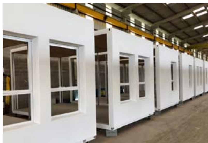
Módulos com fechamento GRC dentro da fábrica da VISIA.
